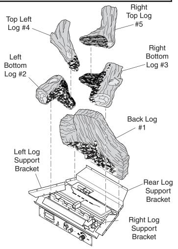
Figure 14 - Installing Logs to Grate (VF30)
